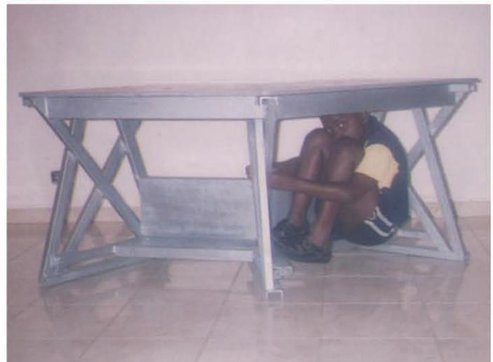
Adapter les tables scolaires à notre situation en zone III à forte sismicité. Prototype conçu par un ingénieur martiniquais.
